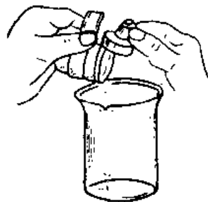
图 III-38 将试样从称量瓶倾入容器中
